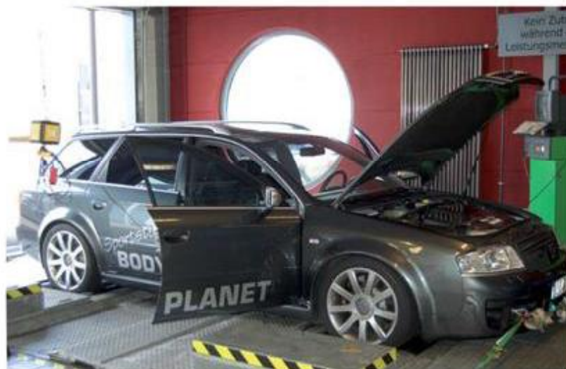
Ein Fahrzeug auf dem Mess- und Leistungsprüfstand
